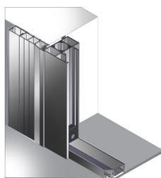
B: Montage en tunnel avec profil large intérieur
