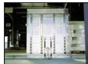
Compensation par vérin(s) à gaz
