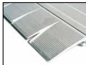
Lèvre segmentée permet de rattraper maxi 40 mm de dévers
